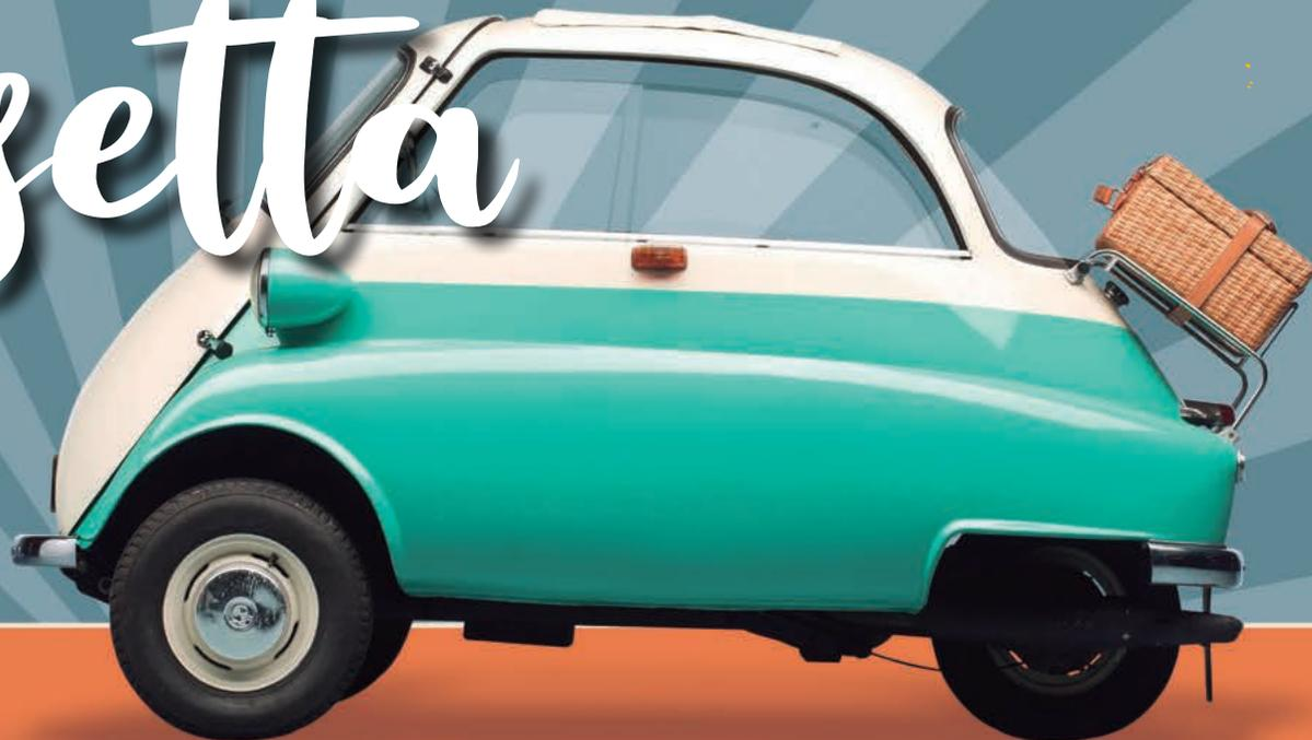
**E**l BMW Isetta es un mini vehículo construido con licencia de la Bayerische Motorenwerke de 1955 a 1962. El «Motocoupé» fue desarrollado por el fabricante italiano Iso Rivolta y es uno de los llamados coches burbuja. Las características del Isetta son la puerta delantera y el motor de cuatro tiempos de un solo cilindro en la parte trasera.
